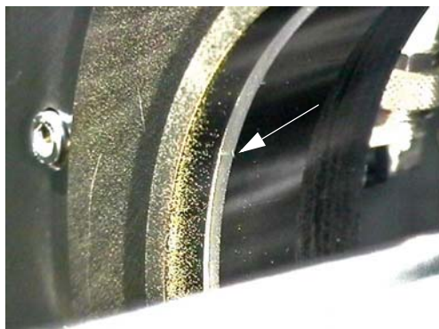
Bild 4.32 Welle 1: Sperrluftparameter unterhalb der Ablagerungsgrenze - undicht, der Pfeil deutet auf die Position der Sperrlufteinleitungsnut
