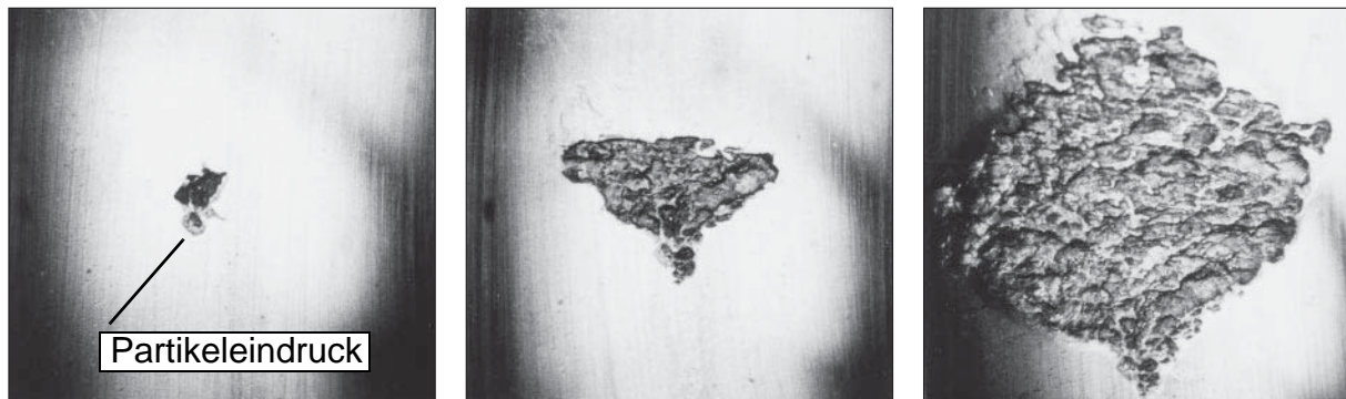
Bild 3.9 Durch Fremdkörpereindrücke verursachtes Pitting breiten sich in Überrollrichtung V-förmig aus, links - Schaden zur Zeit der Erkennung, Mitte - Schaden nach ca. 1 000 Betriebsstunden, rechts - Schaden nach ca. 1 200 Betriebsstunden /37/
