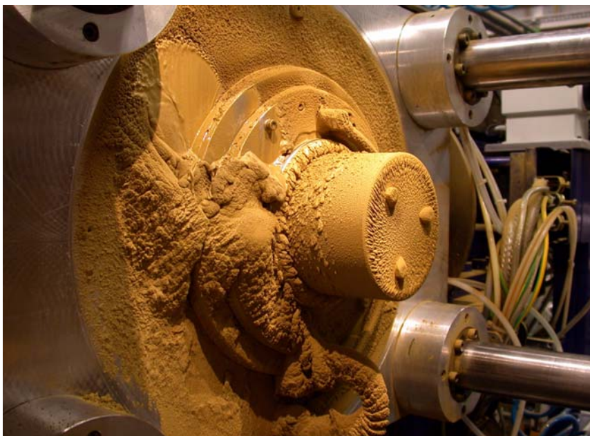
Bild 2.8 Dichtsystem nach Minimalmengenschmierversuch, es sind dicke Partikelablagerungen im Arbeitsraum im Bereich der Dichtstelle zu erkennen
