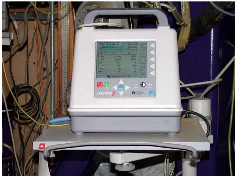
Bild 2.9 Partikelzählgerät mit Monitor, Messprotokoll der Messdaten
