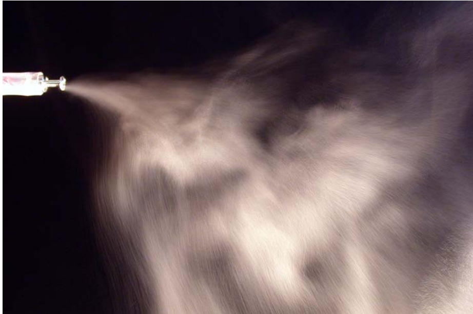
Bild 2.7 Ölnebel durch Ultraschallzerstäubung
