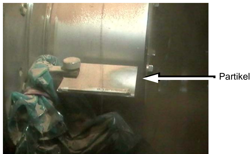
Bild 4.2 Glasplatten während der Partikelbeaufschlagung in Raumlage 1
