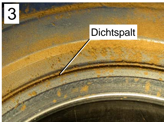
Bild 4.85 NILOS LST-O Ringe nach Versuch mit erhöhtem Druck im Arbeitsraum
