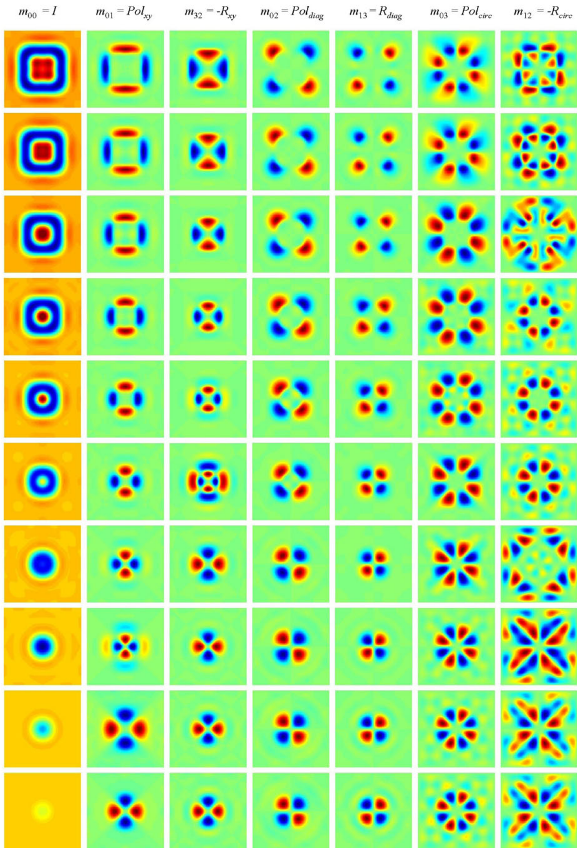
Abb. 8.15: Müller-Matrix-Elemente der Rechteckstruktur, Kantenlänge 1000 nm bis 100 nm.
