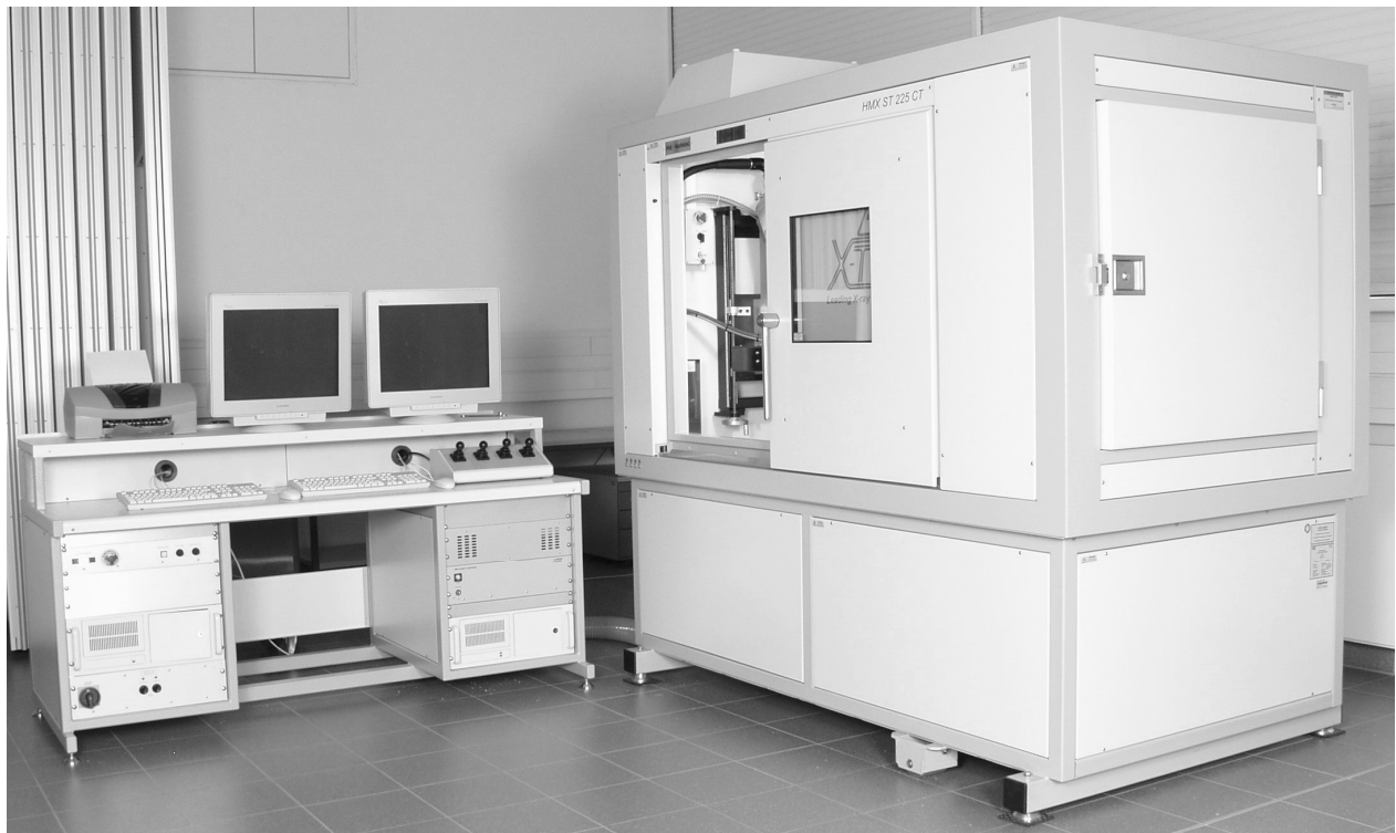
Abbildung 3-2: Foto eines industriellen CT [Quelle: XTek Anlage am Fraunhofer IPA]
