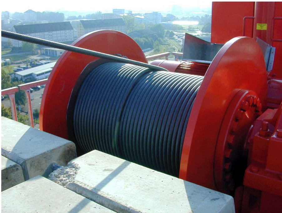
Abb. 1-1: Hubwerk eines Turmdrehkrans mit mehrlagig bewickelter Trommel
