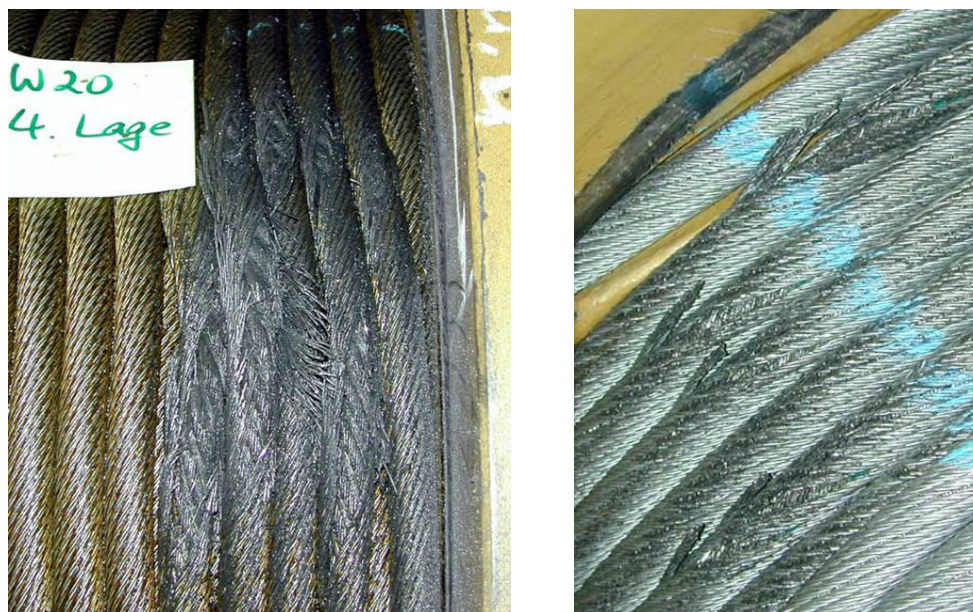
Abb. 1-18: Seilschädigung in der nicht gespulten Lage
