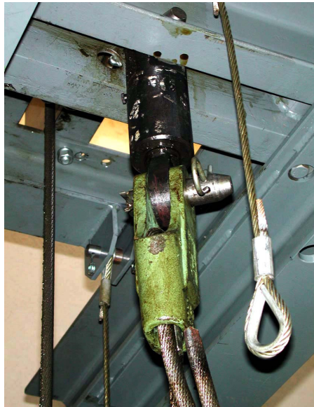
Abb. 3-6: Seilfestpunkt mit Drallfänger und asymmetrischer Keilendklemme
