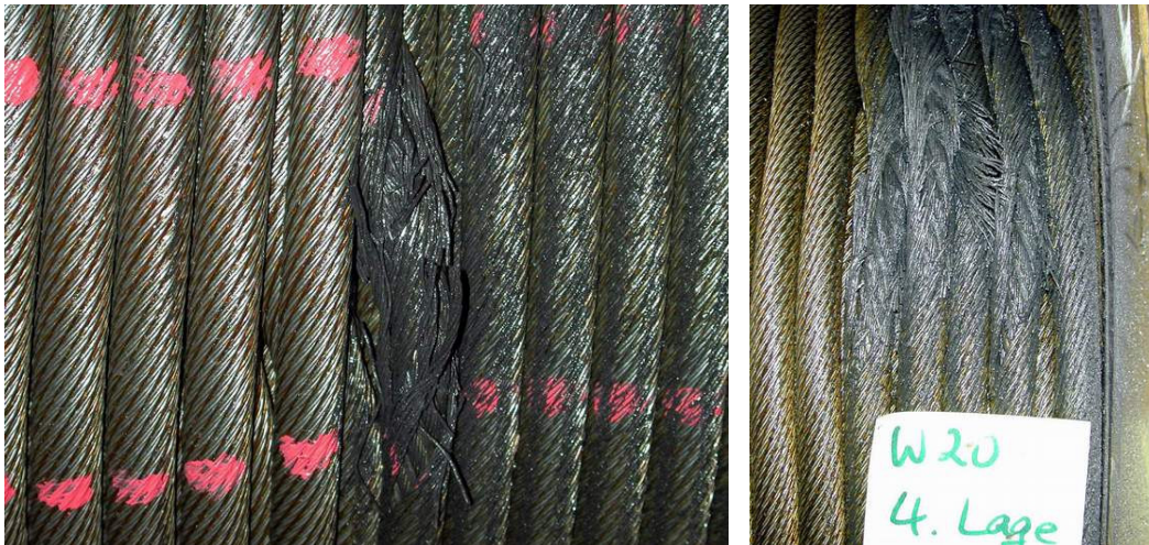
Abb. 3-37: Seilschädigung in der 4., nicht gespulten Lage
