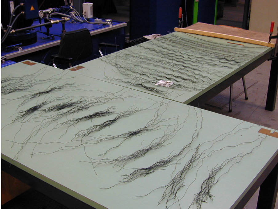
Abb. 3-38: Seilstück aus Praxisseil, zerlegt in Einzeldrähte, sortiert nach Litzen: im Vordergrund die Litzen der äußeren Lage, im Hintergrund die Litzen aus dem Seilinneren
