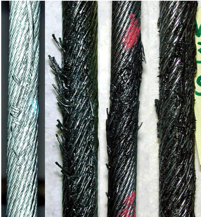
Abb. 1-16: Typische Drahtbrüche in den Steigungszone und beim Lagenwechsel einer Mehrlagenwicklung
