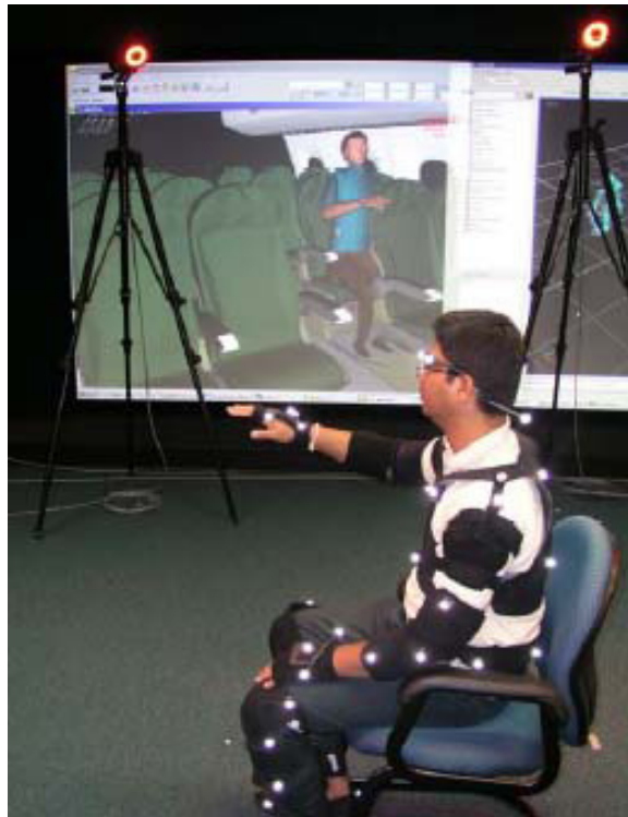
Bild 12 Bewegungsübertragung durch Motion Capturing [Toledo2005]
