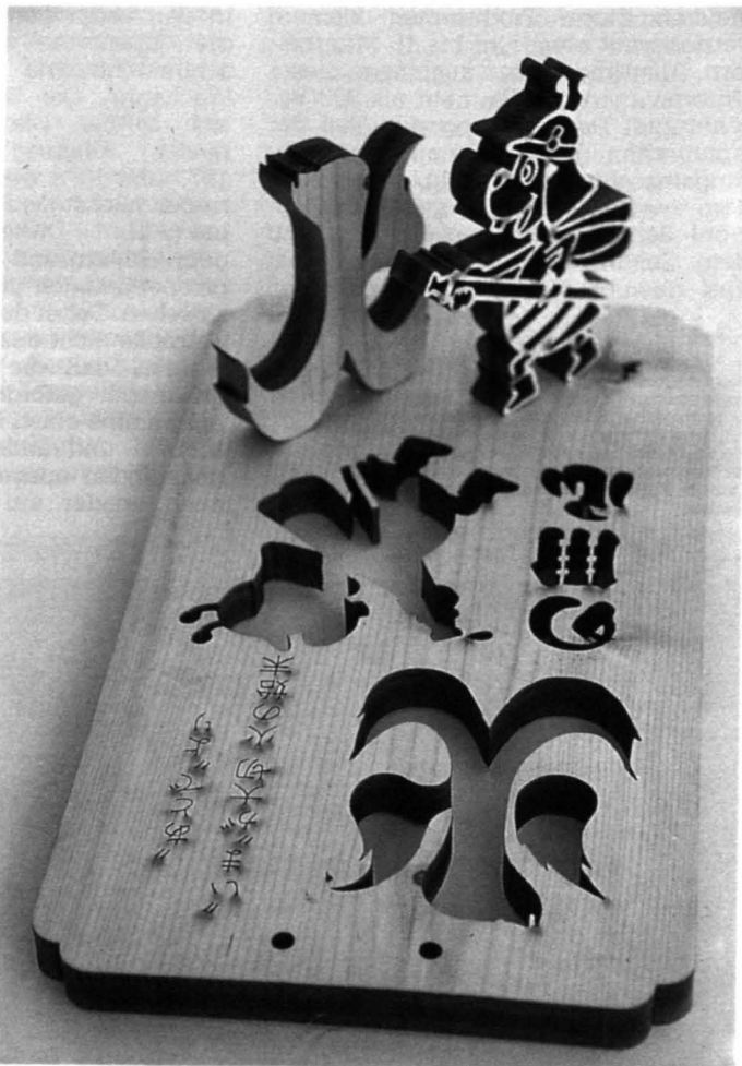
Abb. 5: Mit CO 2 -Laser geschnittenes Holz (Bildnachweis: Verfasser, Laser-Matic)
