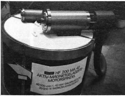
◀ Abb. 12: Magnetgelagerte Hochleistungsspindel mit 40 kW Leistung bei 40000 min -1 (Ibag)
