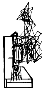
Schwingungsform eines CNC-Bearbeitungskopfes bei 412 Hz
