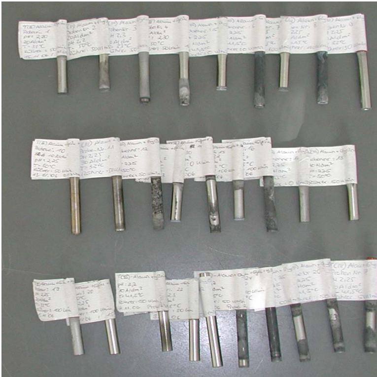
Abb. 41: Versuchsreihe mit Glyzin als Komplexbildner
