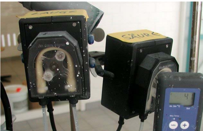
Abb. 32: Schlauchpumpen zum Regeln des pH-Werts
