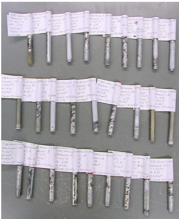
Abb. 42: Versuche mit Diethanolamin als Komplexbildner
