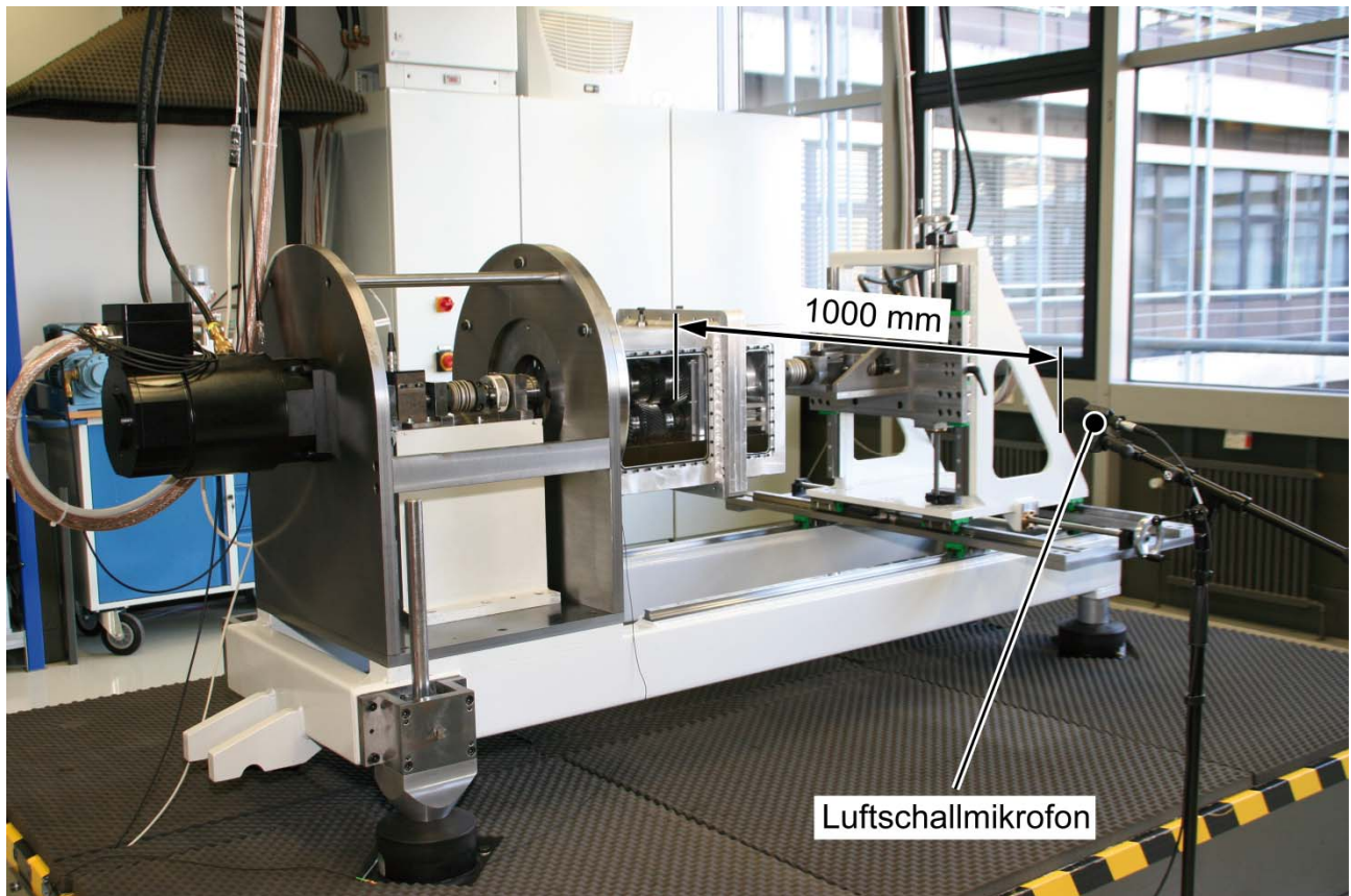
Abb. 6.1. Messaufbau für Akustikuntersuchungen mit montiertem Prüfgetriebe
