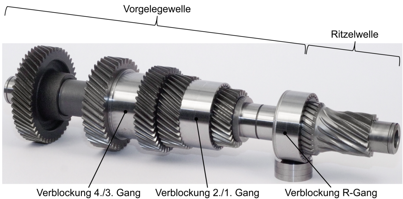
Abb. 4.10. Zusammenbau der Vorgelege- und Ritzelwelle mit Verblockungshülsen zur Nachbildung von Festrädern der synchronisierten Inline-Anordnung
