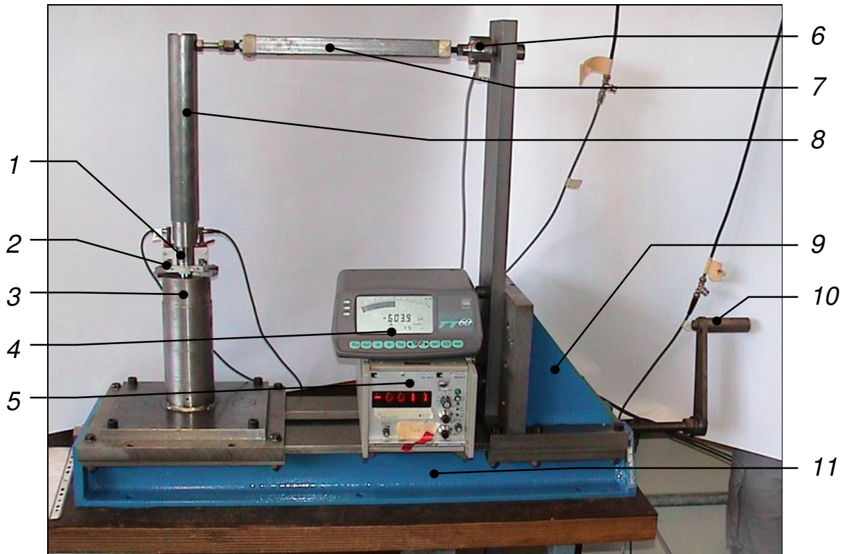
Bild 4.17: Belastungseinrichtung zur Schlupfmessung. 1 Prüfling, 2 Schlupfmessgerät, 3 Probenaufnahme, 4 Längenmessverstärker, 5 Kraftmessverstärker, 6 Kraftmessdose, 7 Zugstab, 8 Verlängerungshülse, 9 Schlitten, 10 Kurbel, 11 Unterbau
