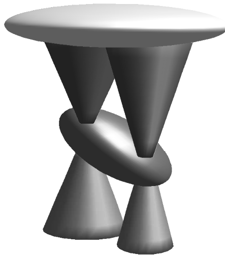
Abbildung 5.3.: Schematische Darstellung des Mehrfalleneinfangs eines länglichen Objektes. Durch die unabhängige Bewegung der Fallen zueinander ist eine beliebige Ausrichtung des Objekts im Raum möglich.
