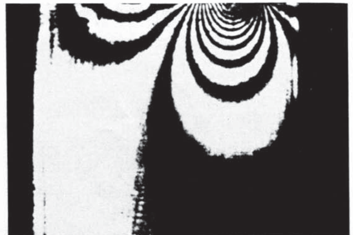
Bild 8 Doppelbelichtung zur Messung der Verformung einer Platte in Echtzeit mit BSO-Kristall als Speicher
