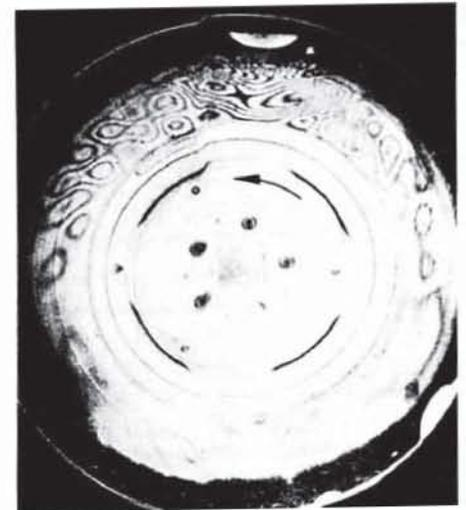
Abb. 3: Interferenzstreifen der Doppelpuls-Holographie nach Abb. 2 mit  $n = 320 \text{ min}^{-1}$ , Pulsseparation  $50 \mu\text{s}$  und Pulsbreite  $40 \text{ ns}$
