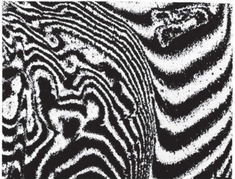
Abb. 11: Echtzeit-Höhenschichtlinienaufnahme einer Münze, Streifenabstand  $13,9 \mu\text{m}$
