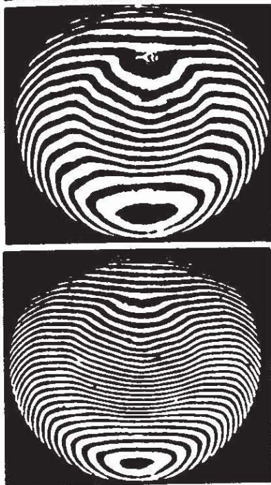
Bild 23.9: Interferogramme einer diamantgedrehten Oberfläche mit Justierfehlern (a) sowie das Ergebnis der eindimensionalen Streifenwertung mit 1024 CCD-Elementen ohne und mit Justierfehlerkompensation (b) bzw. (c)
