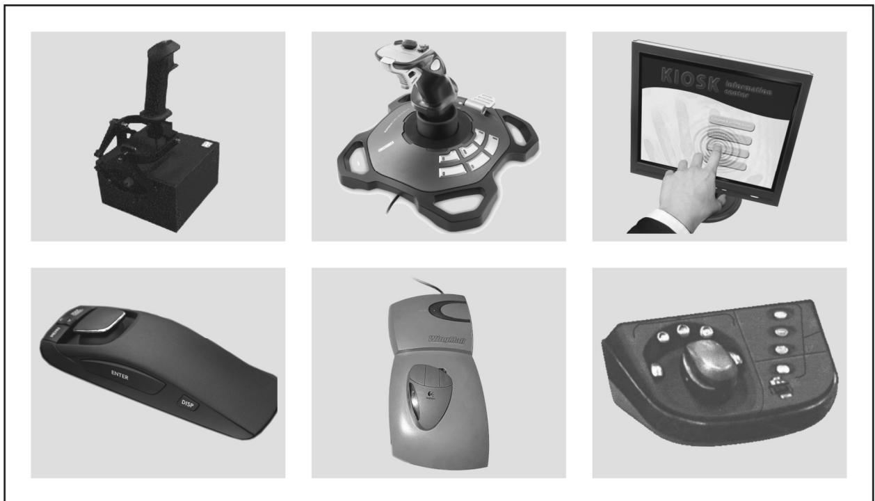
Bild 3.10: Stellteile mit Eignung als Multifunktionsstellteil, von oben links nach unten rechts: Impulse Engine 2000 [IMMERSION99], Wingman Force 3D Pro [LOGITECH07], TouchSense [IMMERSION06], Remote Touch [LEXUS09], WingMan Force-Feedback-Mouse [LOGITECH99], Car-Mouse [ALPS98]
