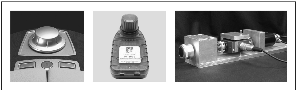
Bild 3.11: Beispiele für Drehsteller mit aktiver haptischer Rückmeldung: BMW iDrive (links) [Bmw01] und TouchSense PR-1000 (Mitte) [IMMERSION07], Prüfstand eines aktiven Drehstellers (rechts) [REISINGER09]
