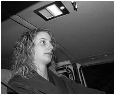
Abbildung 10: Prototyp einer Vigilanzleuchte von Volkswagen (Licht, 2007)
