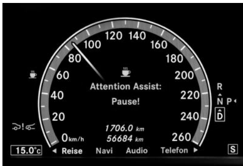
Abbildung 8: Instrumentenanzeige beim System Attention Assist von Mercedes-Benz (Daimler, 2008 b)
