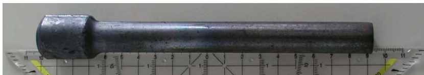
Abbildung 4.2.: Für die Vorversuche sowie im weiteren Verlauf für Versuche verwendetes Schmiedeteil.
