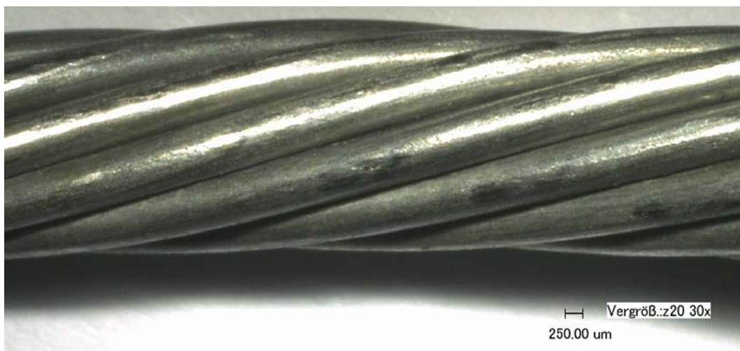
Abb. 7.1: Litze Seil A im Neuzustand ohne signifikante Kerben an den Drahtoberflächen (x30, N = 0 )
