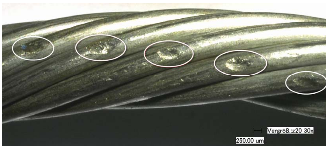
Abb. 7.2: Litze Seil A nach Zugschwellversuch mit \omega = 0 mit einer Kerbe je Draht (x30, 2S_a/d^2 = 200 \text{ N/mm}^2 , S_u/d^2 = 300 \text{ N/mm}^2 , N = 102.895 )
