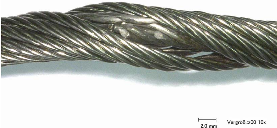
Abb. 7.5: Deformierte und innen gebrochene Seileinlage Seil A ( \times 10 , 2S_a/d^2 = 200 \text{ N/mm}^2 , S_u/d^2 = 300 \text{ N/mm}^2 , \omega = -360^\circ/100d , N = 139.972 )
