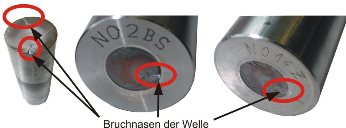
Bild 3.6: RDB-Schäden (gebrochene Wellen mit Bruchnasen)
