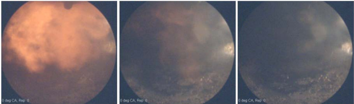
Abbildung 15: Unterschiedlich ausgeprägte Rußbildung für verschiedene AGR-Raten beim DCCS-Verfahren [50] S. 281
