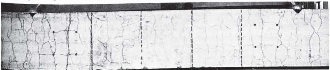
t) S 2.8 ( \lambda_{\text{II}} = 1,74 a_0 , Stöße um 0,5 \lambda_{\text{II}} gegeneinander versetzt, Biegebruch) die gestrichelten Linien kennzeichnen die Stoßenden
