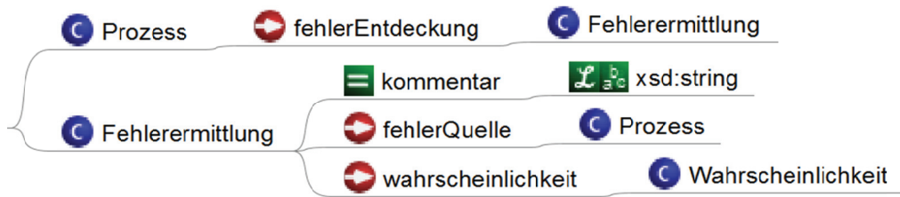
Abbildung 47: Darstellung einer kommentierten Verbindung von Fehlerquelle und -entdeckungsort (Auszug aus dem dynamischen Verhaltensmodells). In dem ersten betrachteten Anwendungsfall in Kapitel 9.1 wurde dieses Konzept realisiert, implementiert und erprobt.
