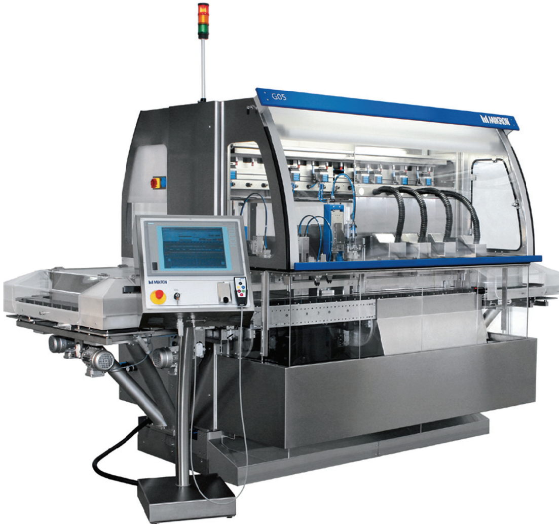
Abbildung 67: Abbildung der Produktlinie, welche für den zweiten Demonstrator zur simulierten Montage medizinischer Injektionsnadeln eingesetzt wurde [FRAME 2011b].
