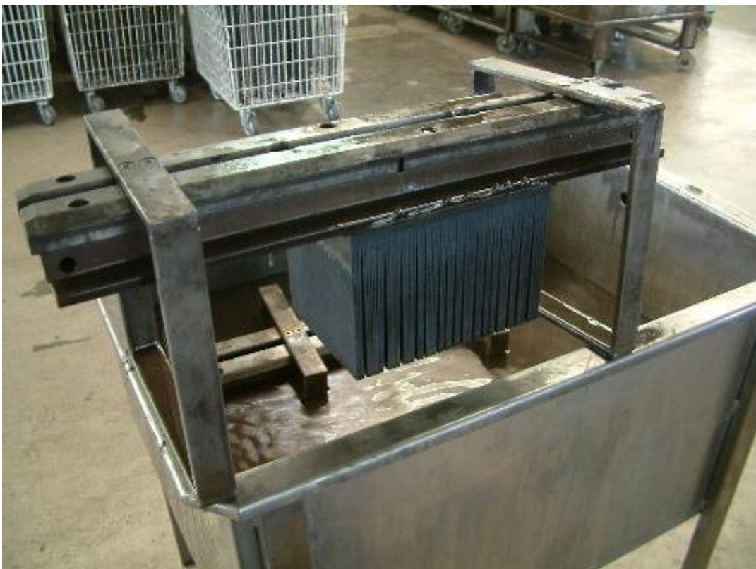
Abbildung 3.2: Transportbecken zur Zwischenlagerung von gesägten Ingots
