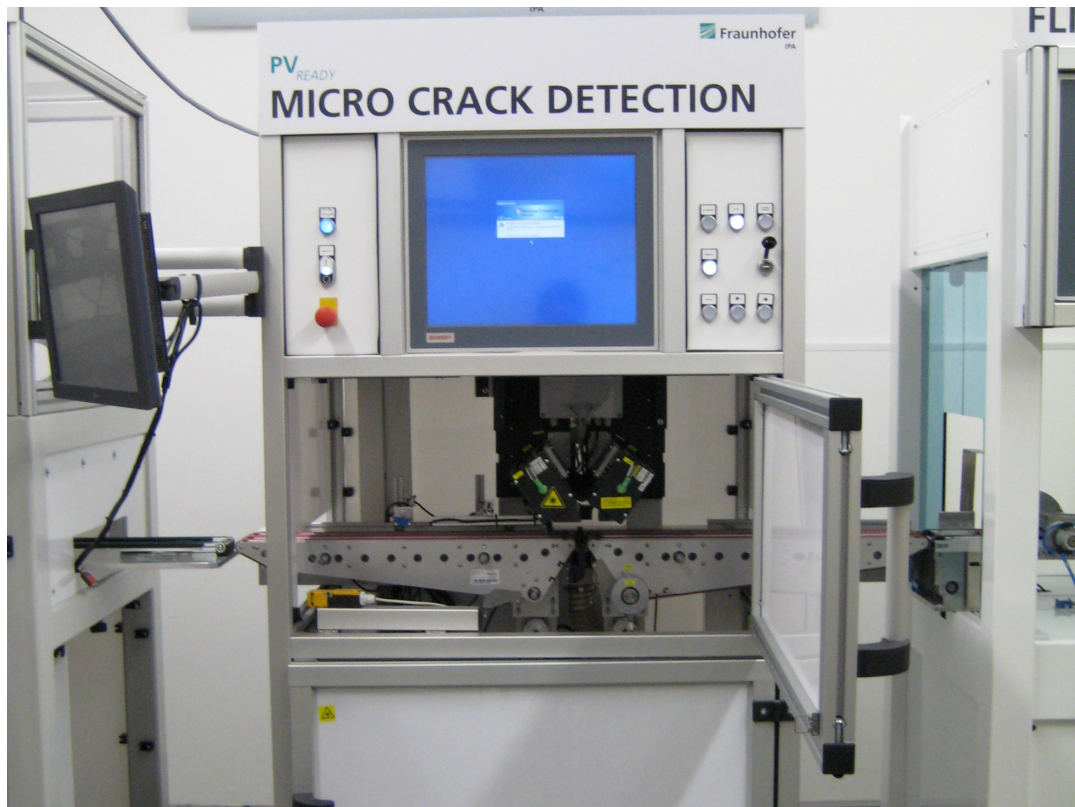
Abbildung 6.5: Prüfgerät zur Mikrorissprüfung mit geöffnetem Durchleuchtungsraum
