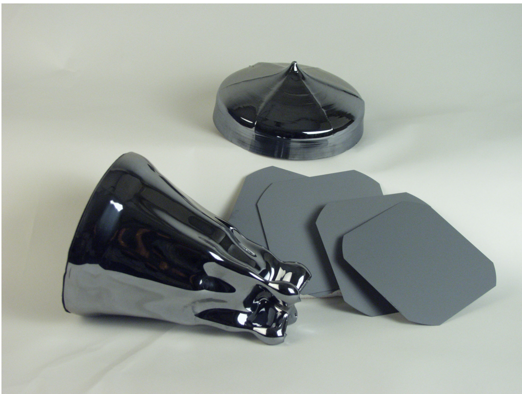
Abbildung 1.1: Gesägte Wafer und Endstücke eines monokristallinen Siliziumstabes
