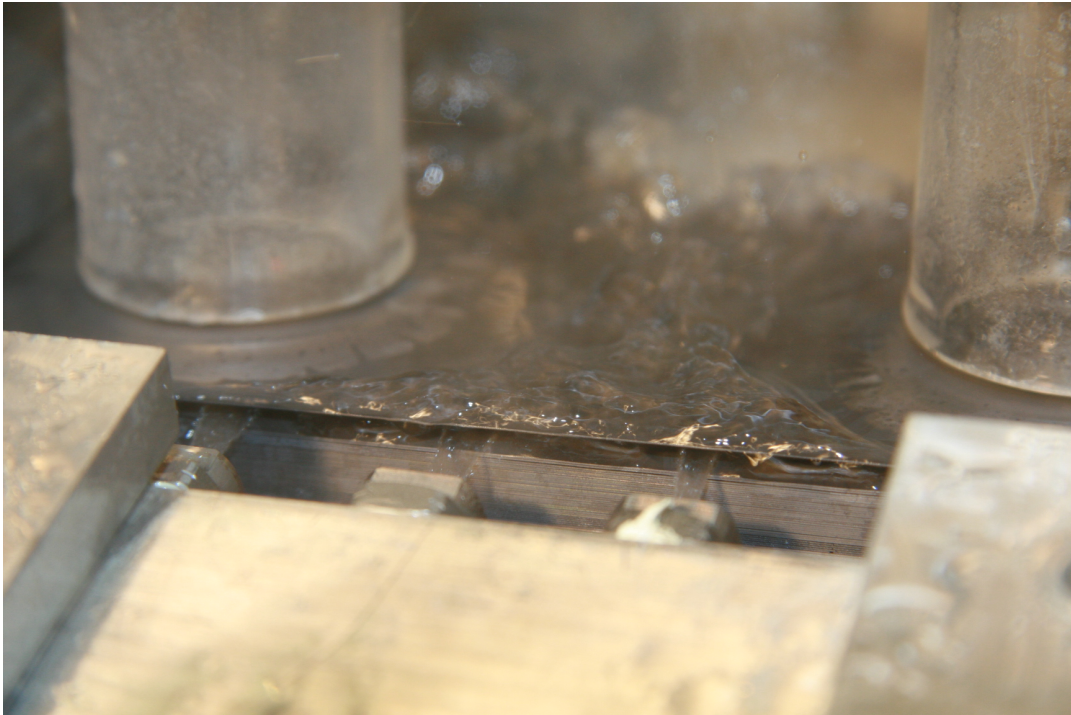
Abbildung 5.17: Wafer mit Anströmung aus einem Winkel von \alpha^h = -10^\circ
