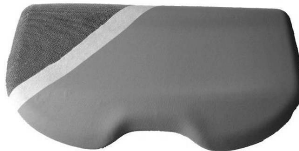
Abbildung 6.10: Sandwichhutablage mit weggesteuertem Werkzeugschließvorgang
