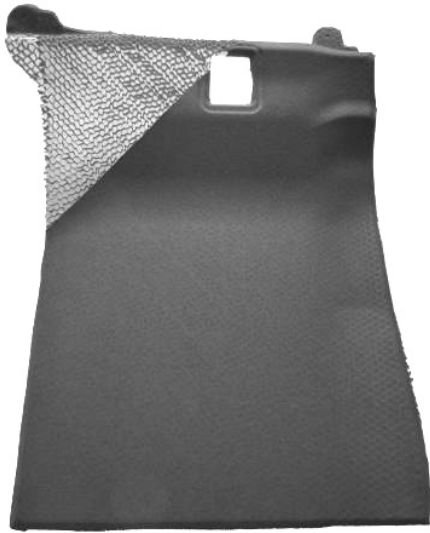
Abbildung 6.11: Verkleidungsteil mit kraftgesteuertem Werkzeugschließvorgang
