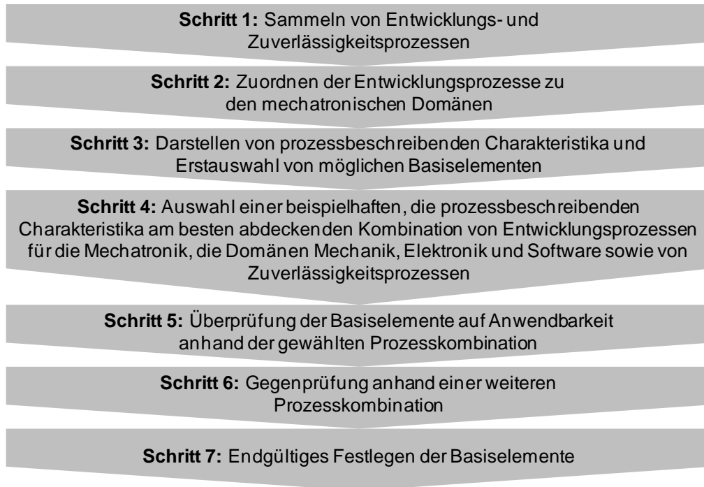
Abbildung 17: Sieben Schritte zur Identifikation von Basiselementen für den Aufbau eines Verknüpfungs- und Zuverlässigkeitsinformationsmodells aus Prozesssicht
