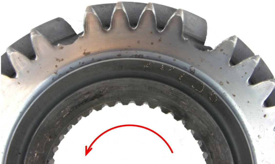
*Bild 4.22: Prüfling mit zwei räumlich voneinander getrennten Bruchstellen*
