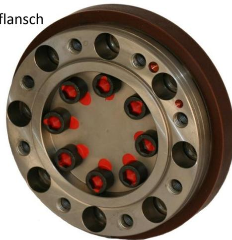
*Bild 4.17: Zwischenflansch und Drehmomentmessflansch der Antriebsseite*
