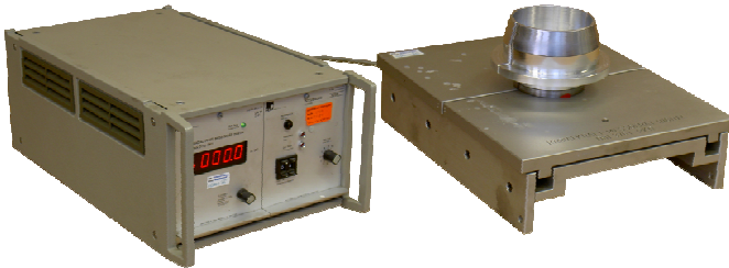
Abbildung 3.5: Radialkraftmessgerät nach DIN 3761-9
