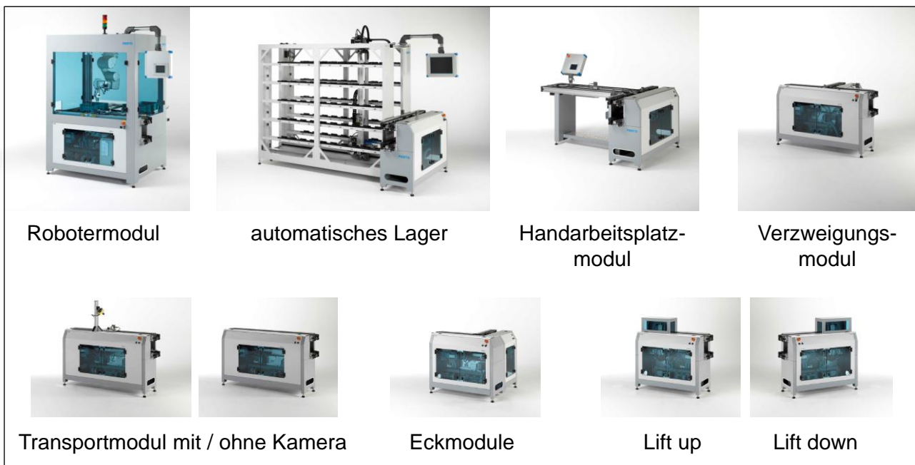
Abbildung 5-3: Funktionale Module des wandlungsfähigen Montagesystems
