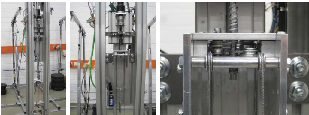
Abbildung 5.14: Beispiel: Reihe 4 - Realisierter bidirektionaler-wirkender Seilzugantrieb
