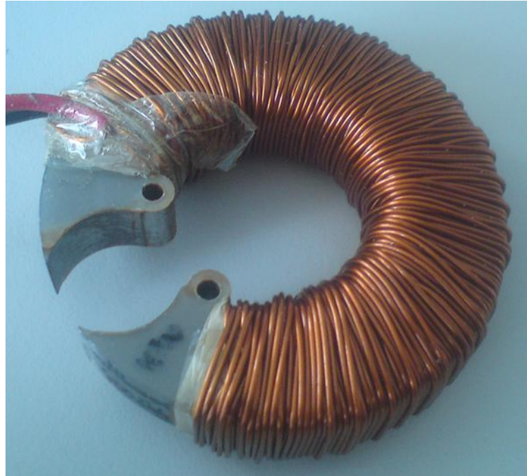
Abbildung 6.8: Elektromagnetische Antriebseinheit des Pumpendemonstrators
