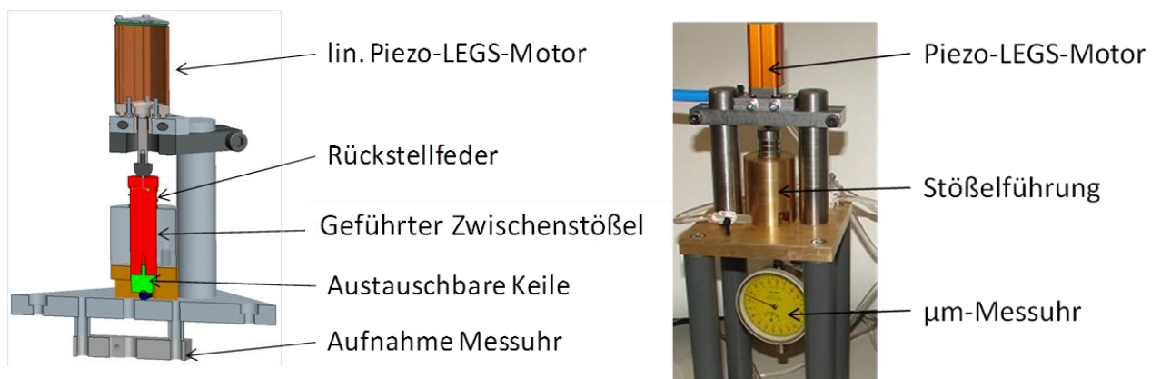
Abbildung 6.11: Aufgebautes Dosierventil im schematischen Schnitt (links) und Gesamtansicht (rechts)
