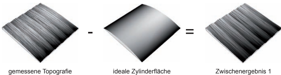
Bild 7.15 Aufarbeitung der Messdaten Schritt 1: Kompensation der Zylinderform mit idealem Zylinder
