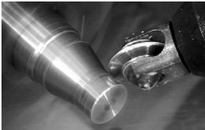
Bild 4.26 Rollieren mit einem Einrollenwerkzeug [111]
