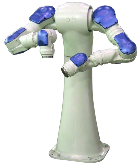
(d) MOTOMAN Multi-Robot Technology: SDA10.
