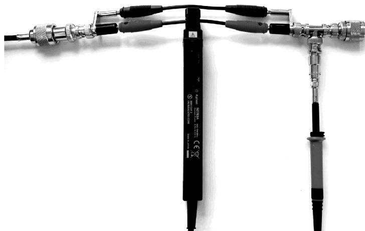
Abbildung 4.6: Messbrücke zwischen Controller und Zünder
