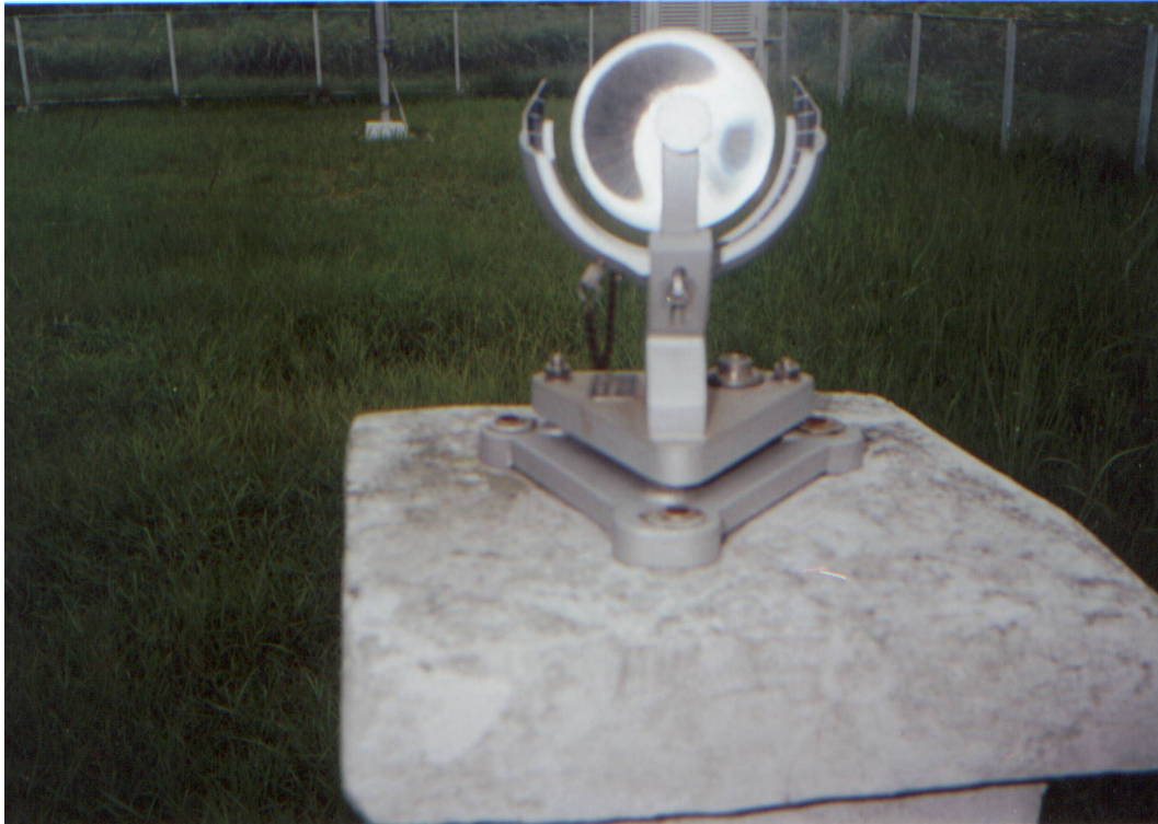
Abb. 23: Sonnenscheindauer-Messgerät [34], wie in Semarang verwendet
