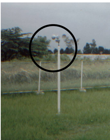
Abb. 26: Anemometer in 2 m Höhe, wie in Semarang benutzt [34]
