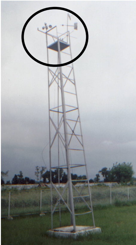
Abb. 27: Anemometer in 8 m Höhe, wie in Semarang benutzt [34]
