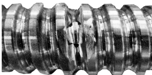
Bild 8.4: Präparation der KGT-Spindel mit einer Schädigung bei Position x = 300 mm
