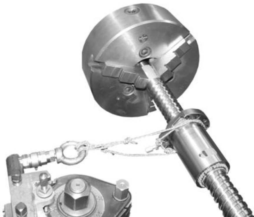
Bild 7.2: Mitlaufender Sensor für die querkraftfreie Ermittlung des Leerlaufdrehmoments
