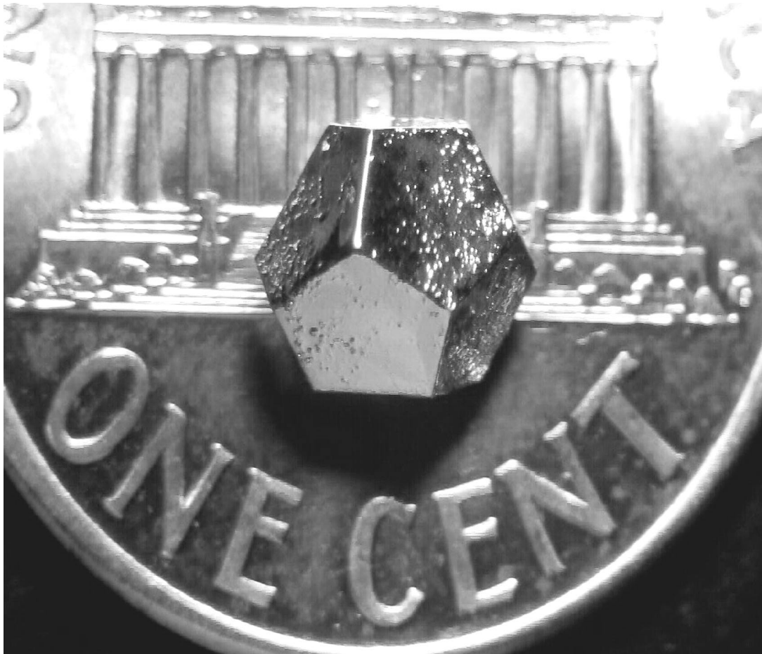
Abbildung 12a: Morphologie eines Zn-Mg-Ho Quasikristalls in der Form eines Icosaeders.
