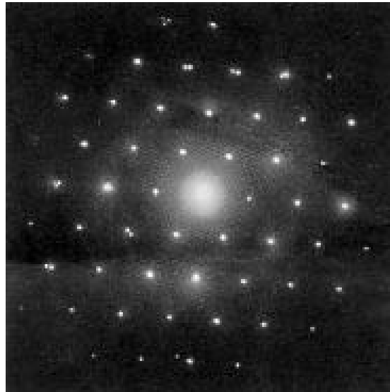
Abbildung 9: Elektronenbeugungsbild des reziproken Gitters in einem hexagonalen Kristall.
