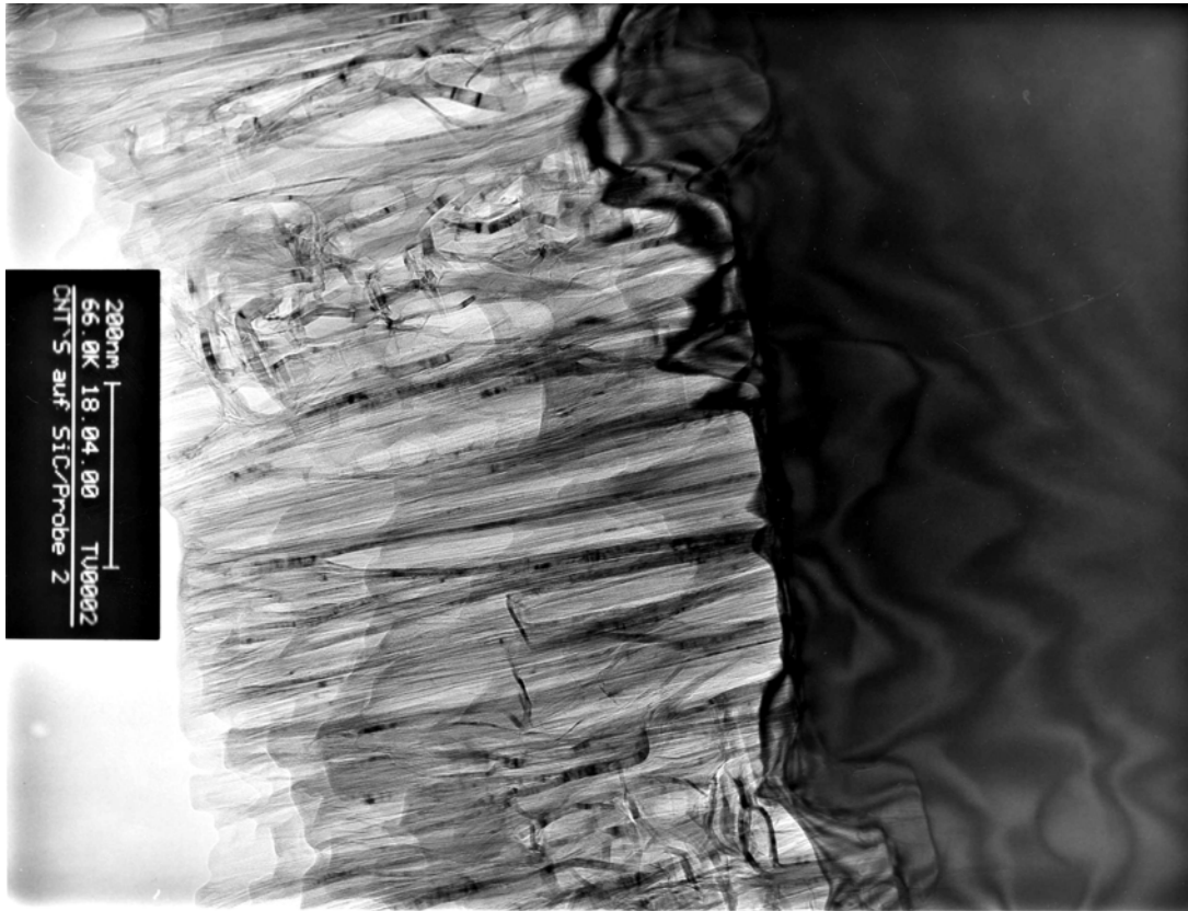
Abbildung A12: TEM-Hellfeldaufnahme der CNT-Schichten mit höherer Auflösung. Die CNTs (heller Saum) sind auf einem SiC-Substrat aufgewachsen (dunkler Bereich). Man erkennt wohl geordnete Bereiche, in denen die CNTs parallel ausgerichtet sind, und Bereiche, in denen die CNTs keine regelmäßige Ausrichtung besitzen.
