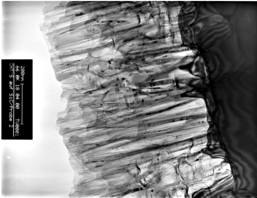
Abbildung A13: TEM-Hellfeldaufnahme der CNT-Schichten mit höherer Auflösung. Die CNTs (heller Saum) sind auf einem SiC-Substrat aufgewachsen (dunkler Bereich). Man erkennt wohl geordnete Bereiche, in denen die CNTs parallel ausgerichtet sind. Zwischen den CNTs und dem Substrat ist eine amorphe Zwischenschicht aus SiC zu erkennen.
