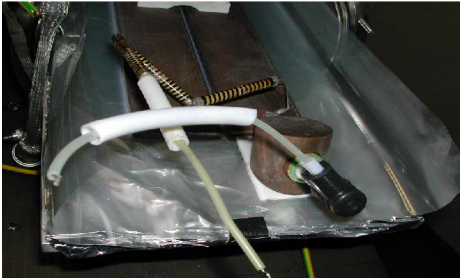
Bild.3.1a Seitenansicht in den Behälter des N_2 -Lasers. Man sieht die beiden über Ladewiderstände verbundenen Messinglineale und die Zündfunkenstrecke (rechts vorne).
