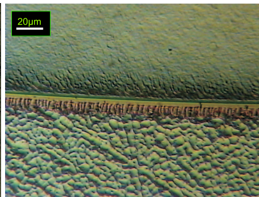
Abbildung 3.16: Ni 55 Pd 45 (10/4), Korngrenze entlang der (100) Orientierung (unten), Lichtmikroskopie, 200-fache Vergrößerung.
