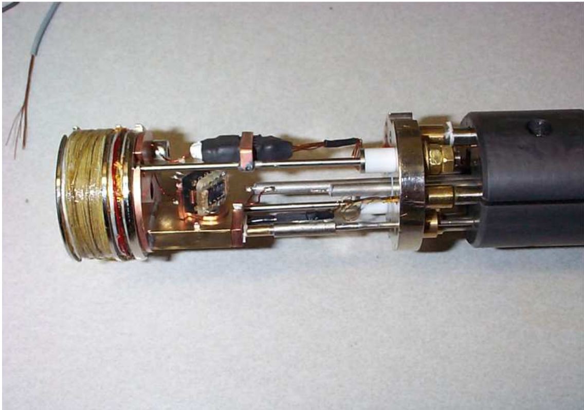
Abbildung 4.7: EDSR-Messaufbau, Gainesville, Prof. Bowers
