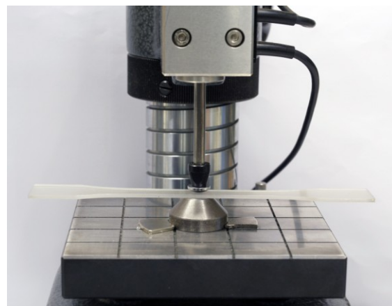
Abbildung 2.11: Links: Stanze zur Stanzung der Probekörper, rechts: Dickenmessung an einem Probekörper mit einem kraftgesteuerten Messtaster Typ HH MT 60M der Firma Heidenhain
