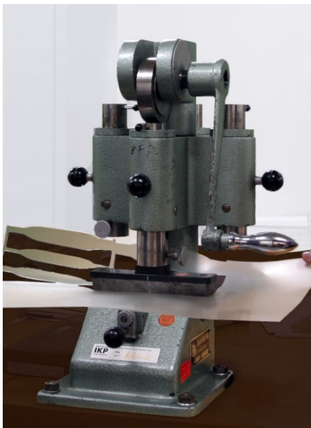
Abbildung 2.11: Links: Stanze zur Stanzung der Probekörper, rechts: Dickenmessung an einem Probekörper mit einem kraftgesteuerten Messtaster Typ HH MT 60M der Firma Heidenhain
