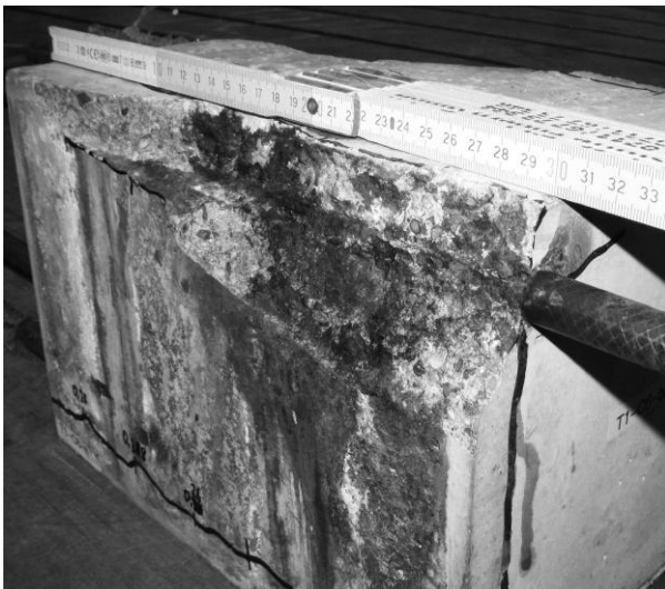
Bild 55: Probekörper mit Betondeckung, die vor dem Herausziehen der Stäbe entfernt wurde: a) Stab T1-C6-2 mit x_{corr} = 0,63 mm und w = 0,90 mm sowie b) Stab T1-C6-4 mit x_{corr} = 0,39 mm und w = 0,73 mm
