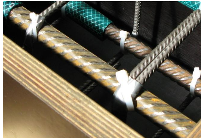
Bild 21: Probekörperschalung mit gegen die Längsbewehrung isolierter Bügelbewehrung, a) im Überblick b) Isolierung im Detail
