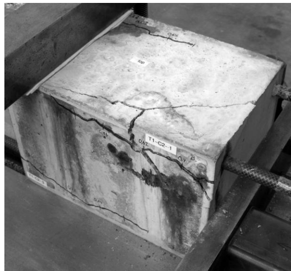
Bild 80: Vergleich der Bruchbilder nach Erreichen der maximalen Ausziehlast eines a) numerischen und eines b) experimentellen Typ 1 Probekörpers aus dem zweiten Korrosionsstadium
