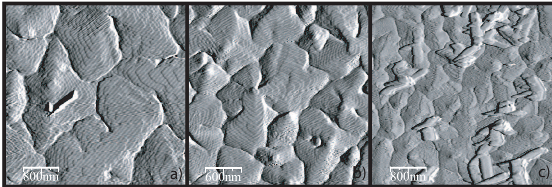
Abbildung 8.9: AFM-Aufnahmen dreier Pentacene-Dünnschichten. Die Filme wurden bei unterschiedlichen Substrattemperaturen T_{sub} aufgedampft: a) 332 K; b) 315 K; c) 303 K. Die Kristallitgröße steigt mit zunehmender Substrattemperatur an.
