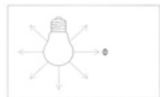
Abb.2.2.2-01. Der Lichtstrom \Phi ist ein Maß für die Lichtleistung einer Lichtquelle; Ganslandt, 1992 S.40
