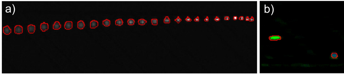
Abbildung 4.7: (a) Übereinandergelegte Einzelbilder eines mit 48 fps erstellten Videos. Es wurde Fluoreszenzbeleuchtung verwendet und eine Monochromkamera eingesetzt. Von rechts nach links bewegt sich das Teilchen aus der Fokusebene. Die detektierte Fläche wird dabei größer, die Intensität der einzelnen Pixel kleiner. (b) Bild einer Farbkamera unter Verwendung eines Dualbandfilters. Die Teilchen sind mit unterschiedlichen Farbstoffen markiert und können getrennt detektiert werden.
