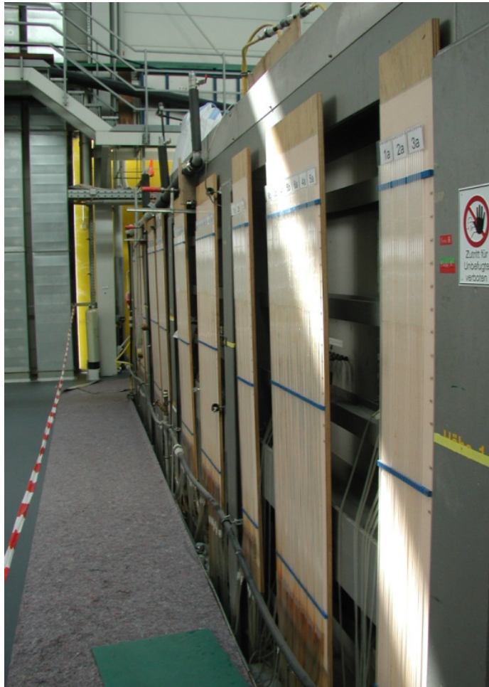
Abb. 7.2: Messharfen und Probennahmestellen am Blockmodell
