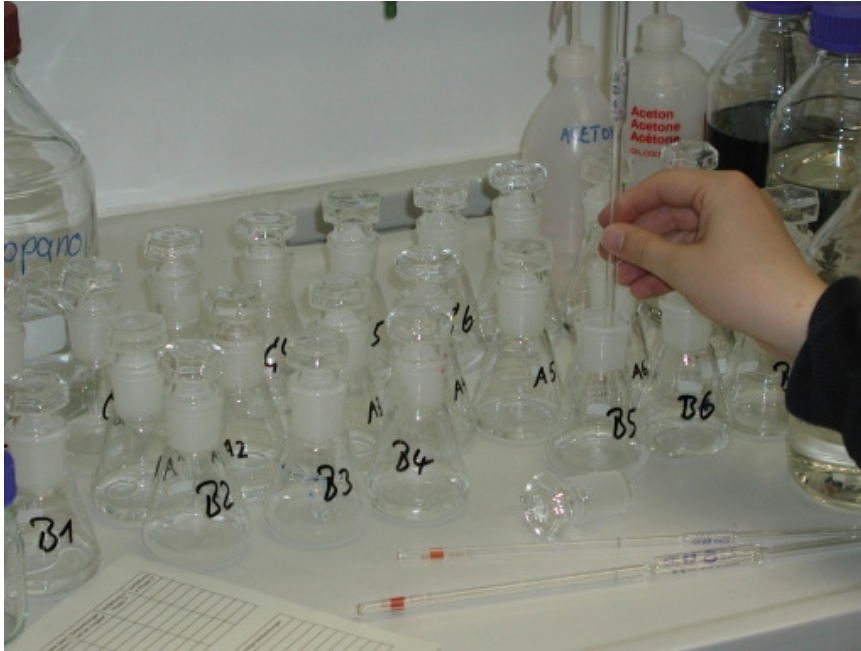
Abb. 4.3: Batchtest zur Bestimmung von binodalen Kurven
