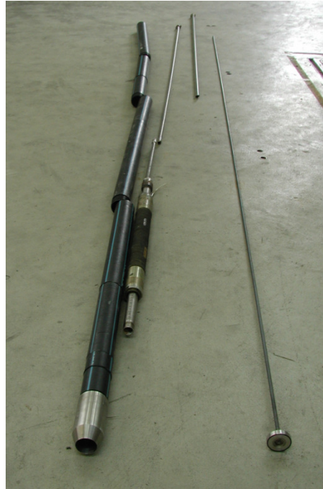
Abb. 7.3: Schematischer Aufbau und Foto des Grundwasserzirkulationsbrunnens
