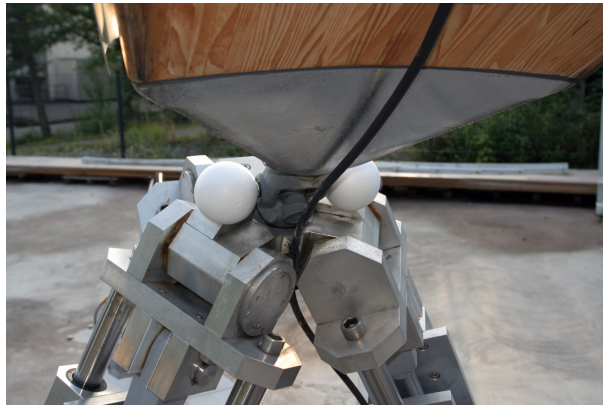
Abbildung 7.7 Detailaufnahme des Auflagers und der Referenzkugeln für den Laserscan. Die Referenzkugeln befinden sich auf einer Achse durch den Drehpunkt des Auflagers, jeweils mit konstantem Abstand zum Drehpunkt.
