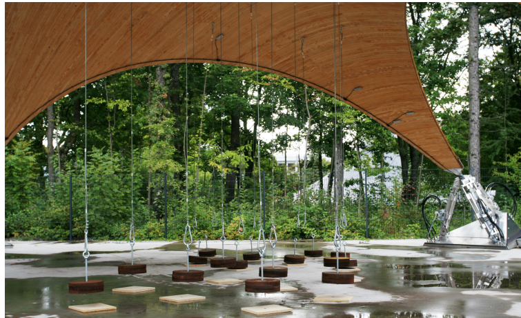
Abbildung 7.15 Belastung des Prototyps zur experimentellen Validierung der Optimierungsergebnisse. Dargestellt im Vordergrund sind die aufgebrauchten Gewichte für den viertelseitigen Validierungslastfall.
