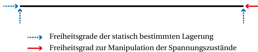
Abbildung 2.4 Freiheitsgrade für die statisch bestimmte Lagerung und zur Manipulation der Spannungszustände am Beispiel eines gelenkig gelagerten Einfeldträgers
