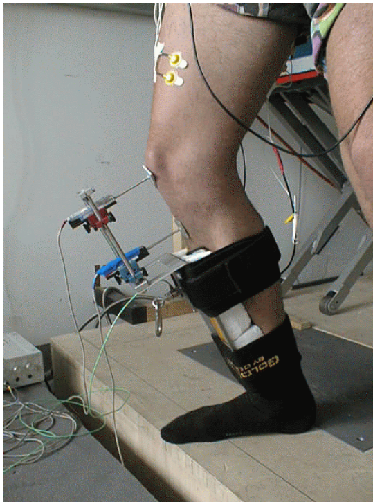
Abb.3-3 Darstellung des Meßgerätes, bestehend aus Referenzgestell und zwei Linearpotentiometern.
