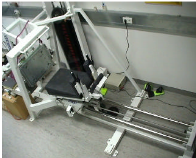
Abb. 3–1: Schlittensprungsystem der Fa. Phoenix mit Messapparatur (von oben gesehen)
