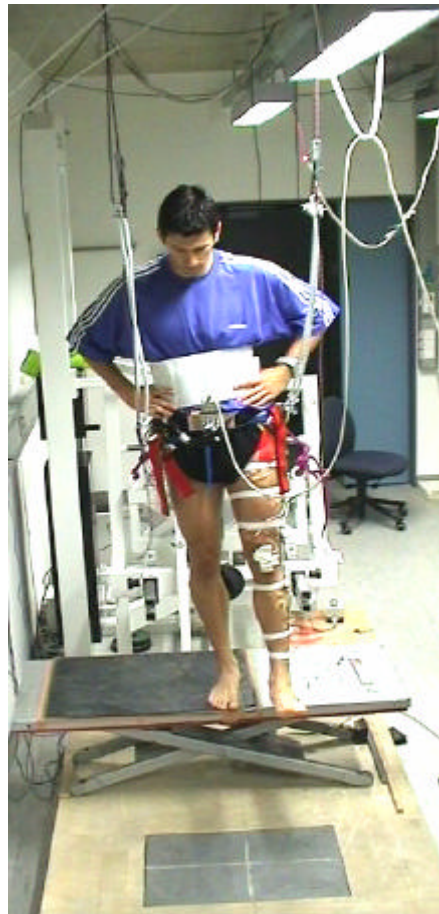
Abb. 6–5: Versuchsanordnung Drop Jump mit Körpergewichtsentlastung.
