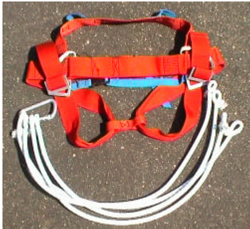
Abb. 6–4: Gurtsystem und Expanderfedern zur Realisierung der Entlastungsbedingungen
